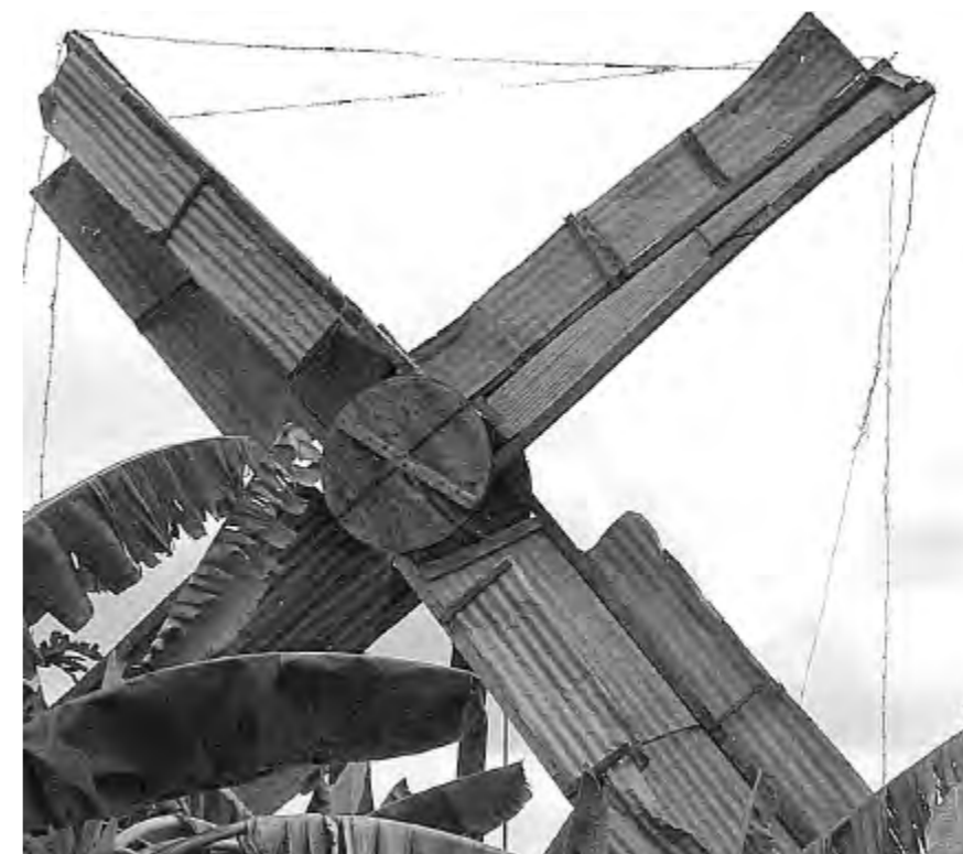
Les pales de la pompe éolienne sont faites de tôle ondulée. Photo: W. Critchley.
