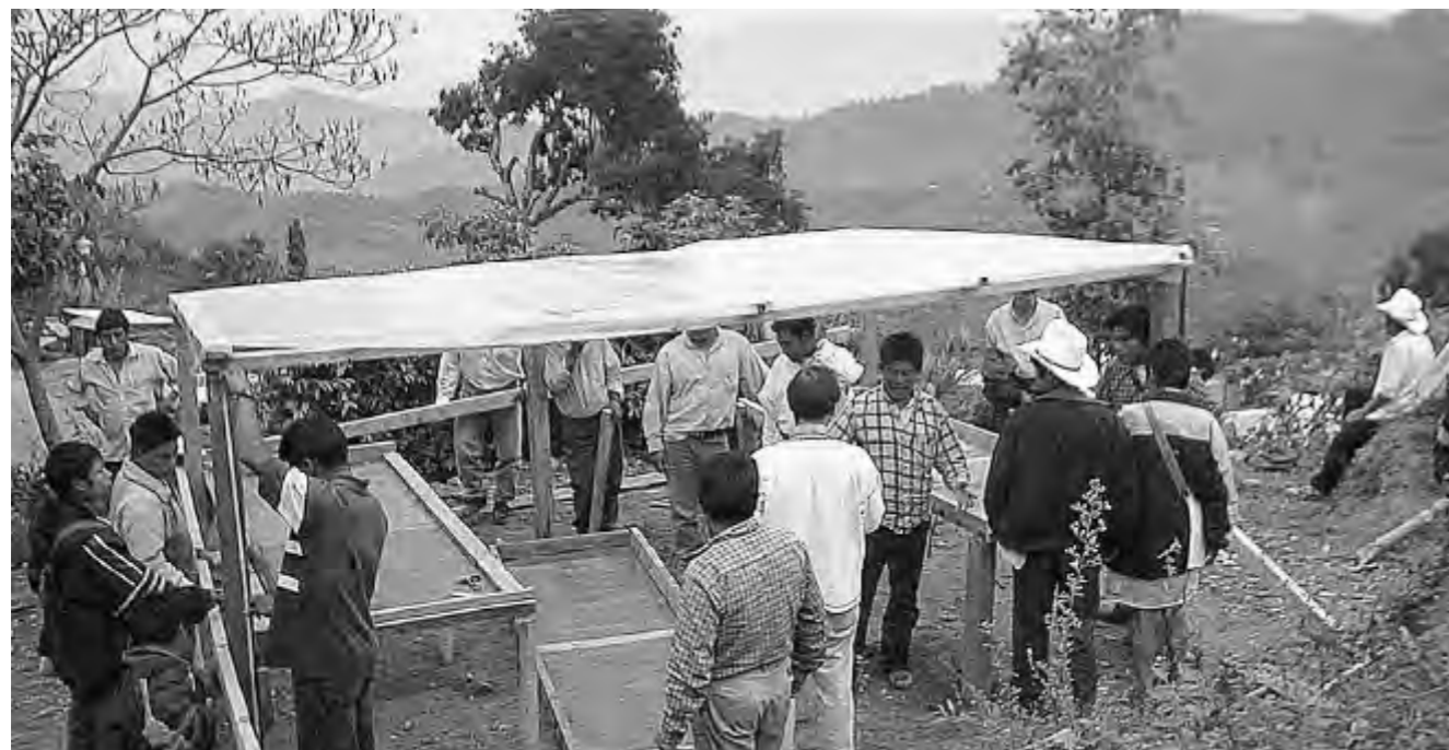
Le séchoir à café solaire est fabriqué avec du bois et du plastique disponibles localement. Les plaques sont faites de bois et de grillage. Photo : Auteurs.
